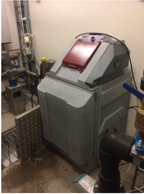
Figur 3: ISCO 5800 Refrigerated Sampler, som benyttes i SE og PAV.
