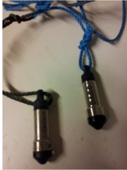
Figur 4: Nivålogger, Diver, ble brukt for å måle vannivå i PAV fra januar til mai 2017.
