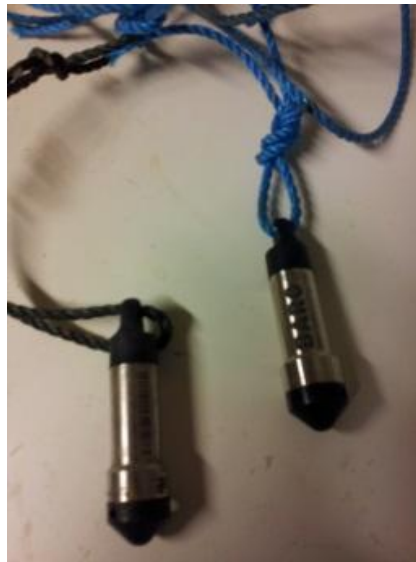
Figur 4: Nivålogger, Diver, ble brukt for å måle vannivå i PAV fra februar til mai 2016.
