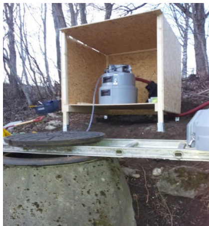
Figur 13. Midlertidig skur for beskyttelse av prøvetaker i utslippspunkt til Stjørdalselva.
