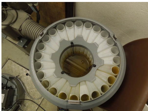
Figur 11. Prøvetaker i PAV hvor 9 døgnflasker er fylt av glykolholdig vann.
