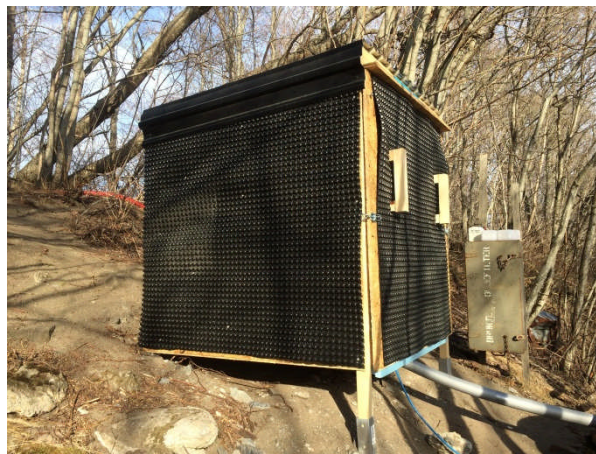
Figur 13. Midlertidig skur for beskyttelse av prøvetaker i utslippspunkt til Stjørdalselva.
