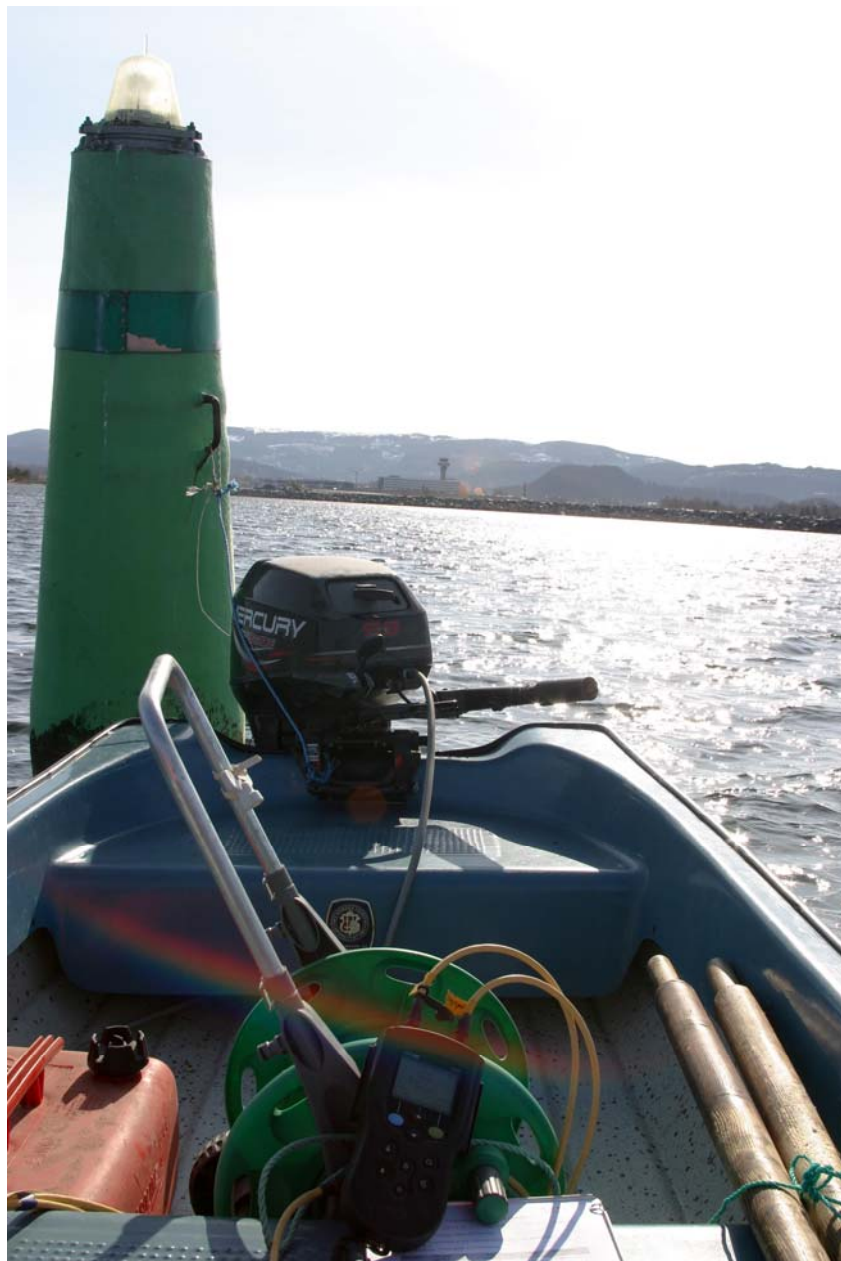
Figur 25. Profilmålinger i det gamle elveleiet og ved kommunalt dyputslipp med Hack multiprobeinstrument.
