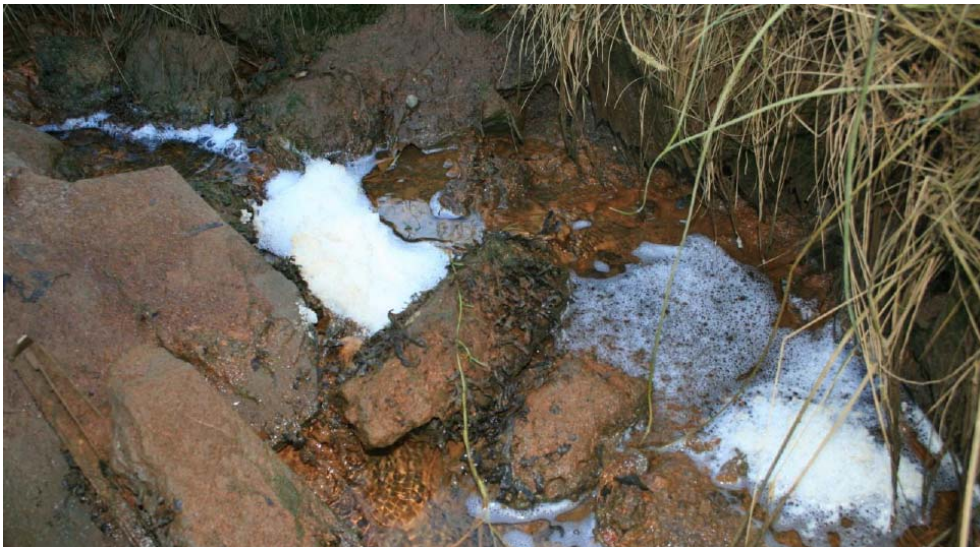
Figur 19. Viser samlegrøft for prøvetaking av avrenning fra OV1 og OV2. Grøfta blir ført til utløp i den nordlige delen av det gamle elveleiet.
