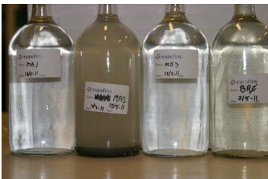
Figur 13. Visuell vannkvalitet for vannprøver fra MB1, MB2 og MB3 samt prøve fra brannøving tatt i mai 2011.
