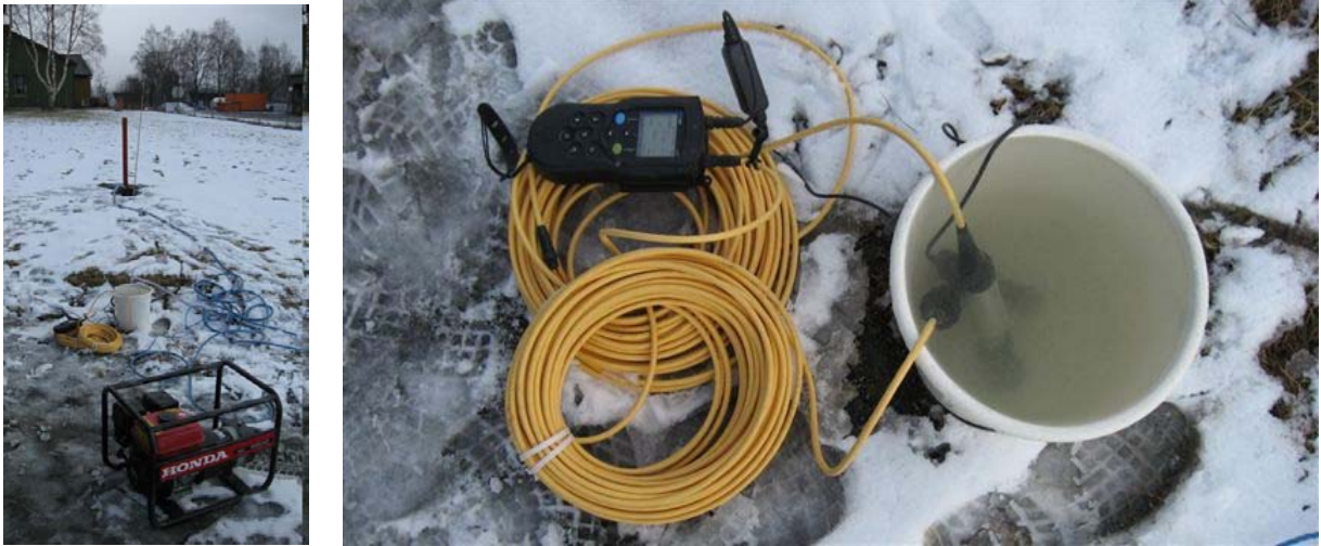
Figur 5. Prøvetaking av brønn ved deicing og måling av oksygen, pH og ledningsevne i grunnvannet.
