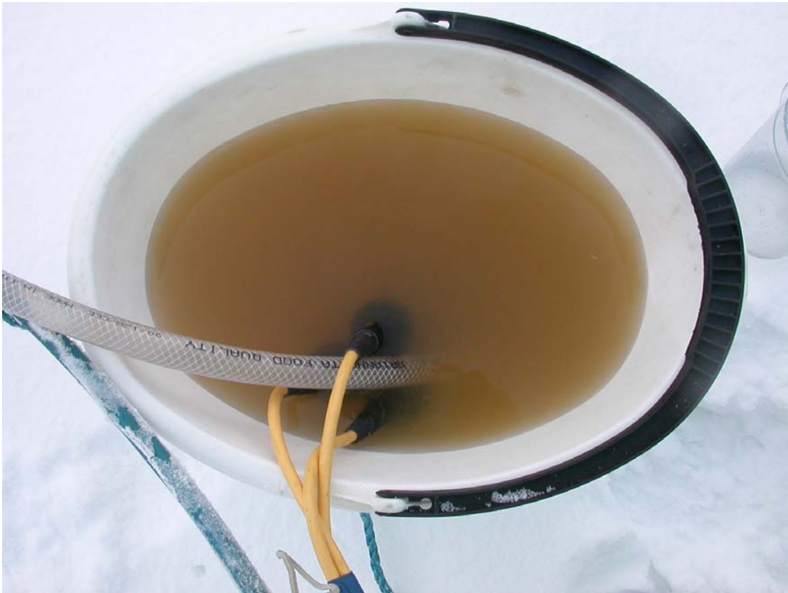
Figur 18. Viser rustbrunt grunnvann fra første pumping for grunnvannsbrønn ved deicing (BRAV).
