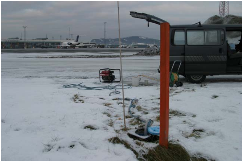
Figur 6. Prøvetaking av brønn ved deicing og måling av oksygen, pH og ledningsevne i grunnvannet.
