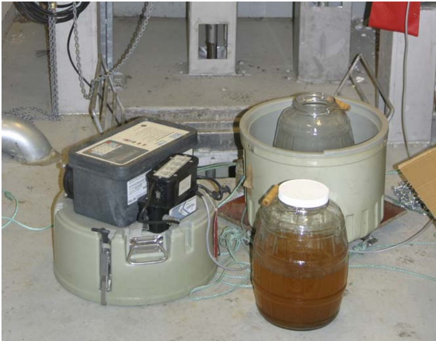
Figur 12. Viser automatisk prøvetaker og prøve fra pumpekum ved feltbesøk sesongen 07/08.
