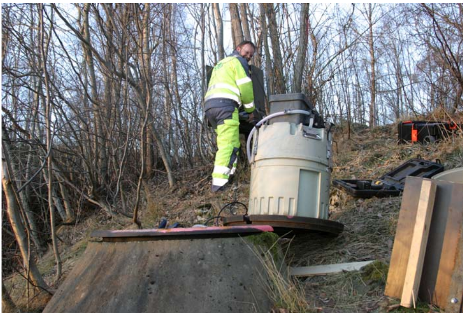
Figur 8. Feltarbeid med henting av vannføringsdata og uttak av vannprøve ved inspeksjonskum for overvann til Stjørdalselva sesongen 07/08.
