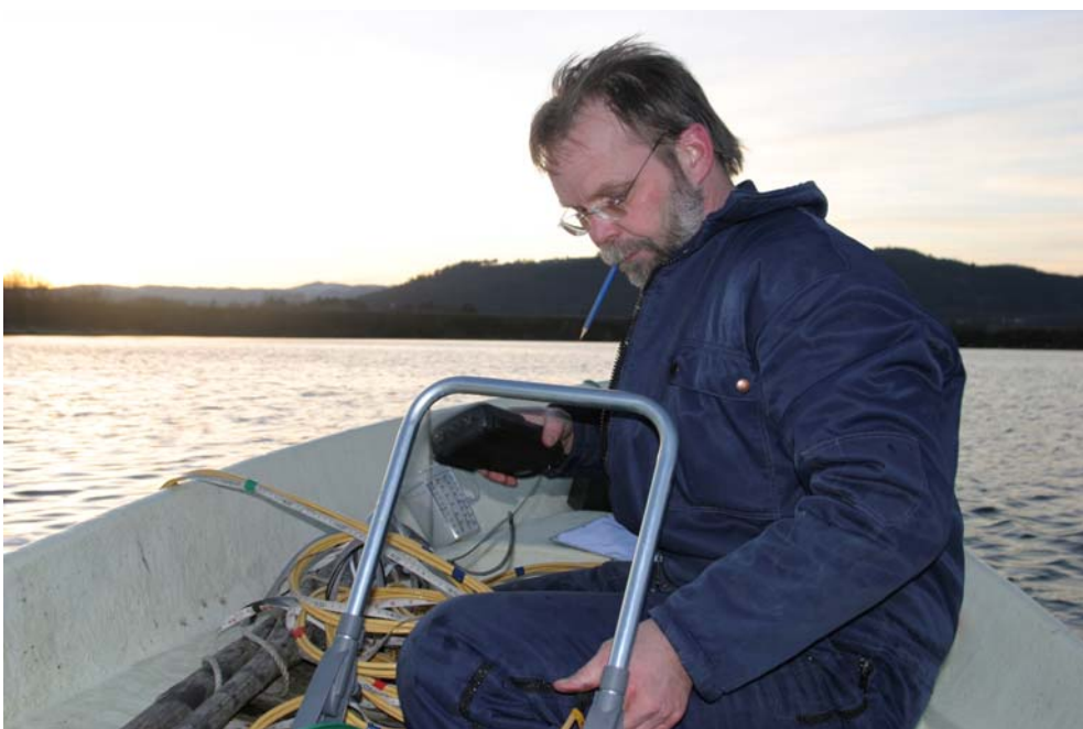
Figur 13. Profilmålinger i det gamle elveleiet med Hack multiprobeinstrument sesongen 07/08.
