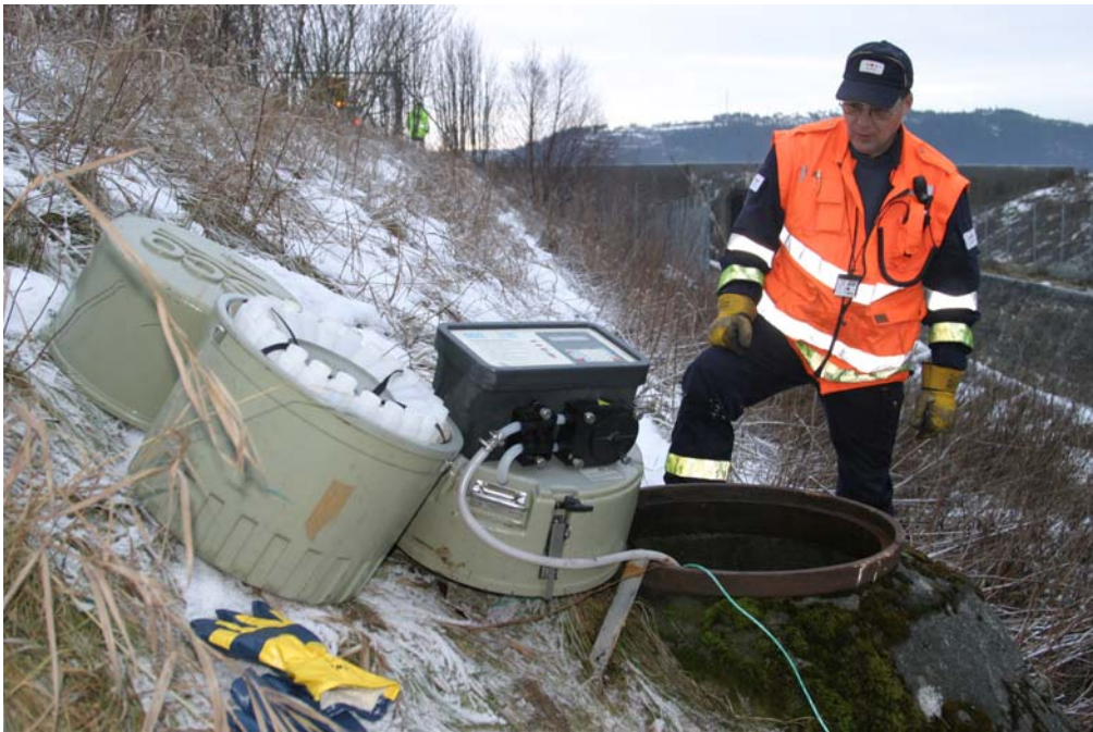
Figur 2. Fra feltbesøk med innhenting av data og vannprøver fra utstyr montert i inspeksjonskum for stor overvannskulvert mot det gamle elveleiet (foto: L. Weiseth).
