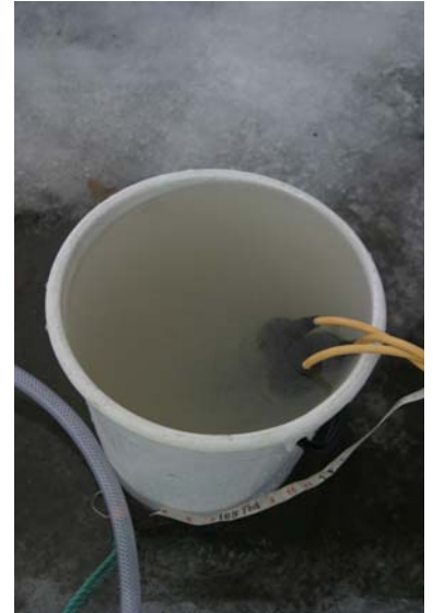
Figur 6. Prøvetaking av brønn ved deicing og måling av oksygen, pH og ledningsevne i grunnvannet.
