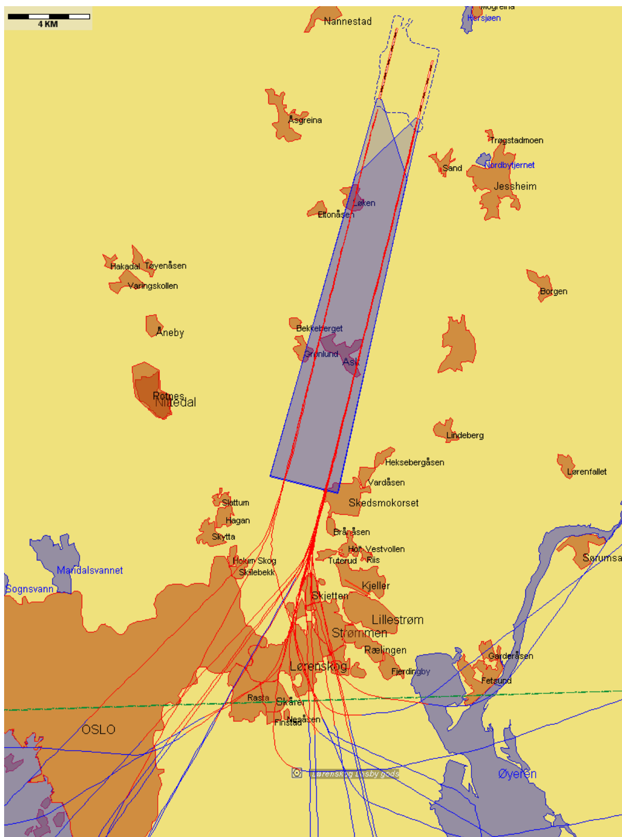
Figur 8. Under minstehøyden sør for N 59 55 00: 21 av totalt 2744 ankomster fra sør (0,77 %). Rødfarget trasé for flygehøyde mindre enn 5000 fot over havet
