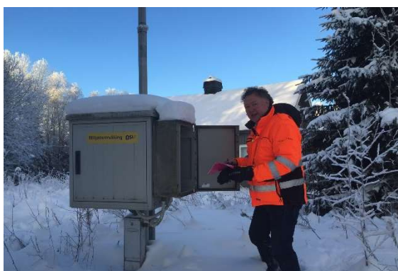
Oslo lufthavns støy- og traséovervåkingsanlegg registrerer støynivået kontinuerlig på 11 punkter rundt flyplassen.
